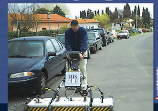
Esempio di acquisizione Georadar per mappatura sottoservizi
